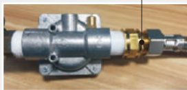
步骤4: 将柔性软管接头的一端 连接到双向转接头的锥部，另一 端连接到输出压力调节器上
