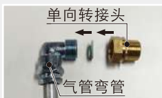
步骤2: 将单向转接头安装到气管弯管上
